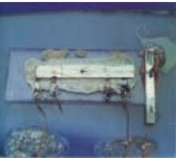
Der erste mit einem Planarprozess gefertigte Transistor, 1959
