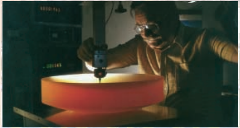
Zerodur-Spiegelträger mit geringster Wärmeausdehnung
