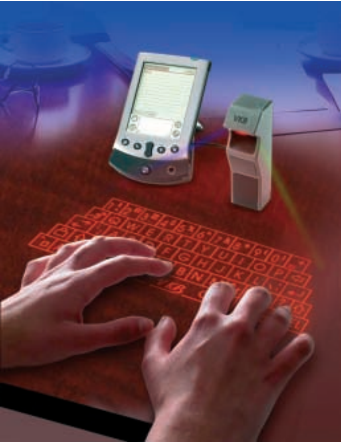
Virtuelle Tastatur: Die Berührung eines projizierten Tastaturelementes wird vom System erkannt und als Tastendruck gewertet
