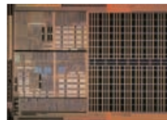
64bit-Prozessor für PC-Anwendungen mit 106 Mio. Transistoren in 130 nm-Technologie
