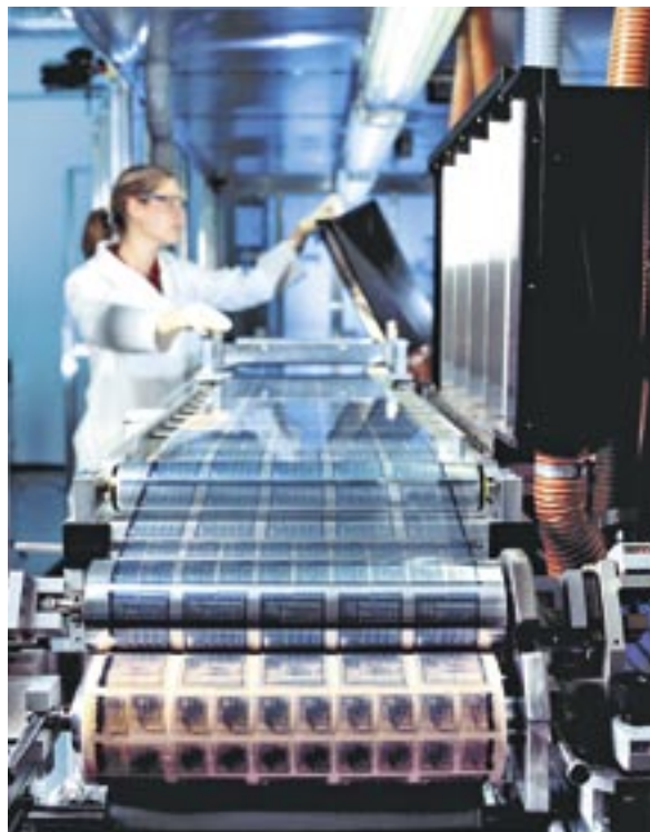
RFID-Chips aus Kunststoff können in Kürze in Massen produziert werden. Deutsche Forscher realisierten die weltweit schnellste, mit 600 Kilohertz taktbare integrierte Schaltung aus organischem Material. Die Plastikelektronik wird in „intelligenten Etiketten“ zum Einsatz kommen.
