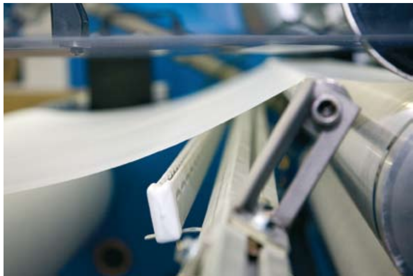
Lithiumbatterien der neuesten Generation haben eine keramische Separatorfolie (Separion®), die auf Rolle produziert werden kann.
